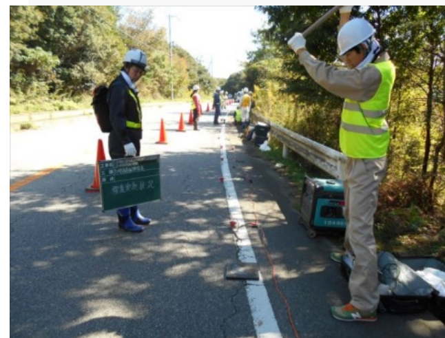
盛土の縦断方向上に測線を展開
